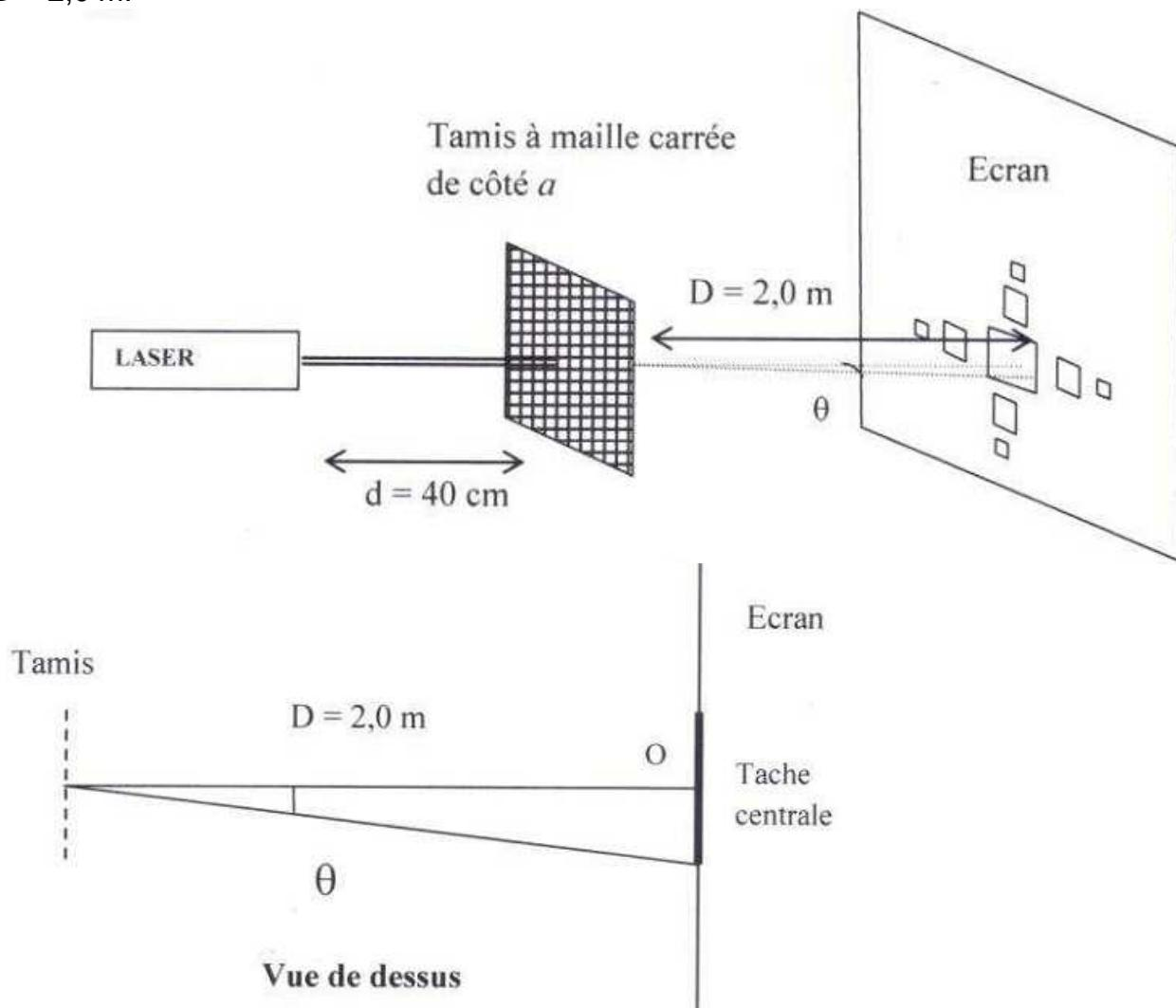
Un tamis à maille carrée possède des propriétés diffractantes identiques à celles observées lors de la superposition de deux fentes allongées de même largeur et disposées perpendiculairement l'une par rapport à l'autre.
