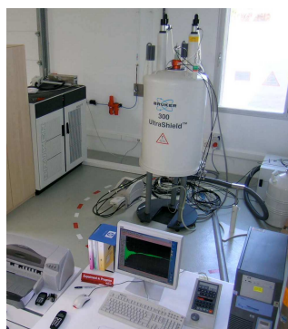
doc.1 Spectromètre RMN
