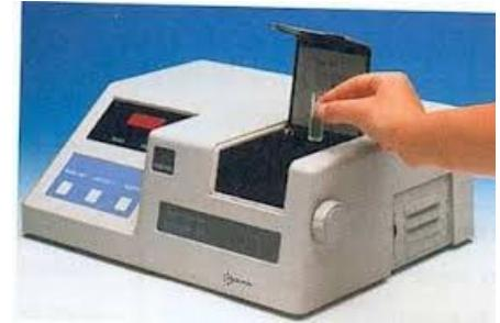
Le spectrophotomètre permet la mesure de l'absorbance A au cours du temps t.
