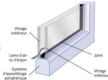
Par exemple, la résistance thermique d'un double vitrage est :
