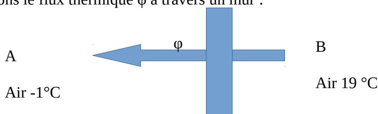
A chaque seconde, une certaine « quantité de chaleur » ou transfert thermique  $Q$  passe de B à A. Le flux thermique  $\varphi$  correspond à cet écoulement de chaleur de B vers A. Il est donc défini par la formule :
