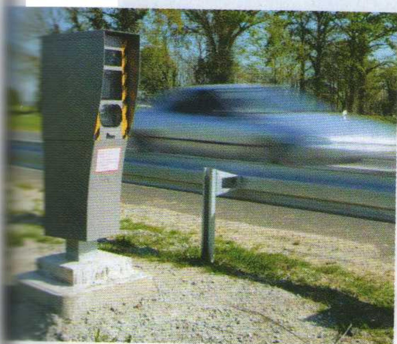
Le cinémomètre Mesta 208® est utilisé afin de contrôler par effet Doppler la valeur de la vitesse instantanée des véhicules automobiles.
