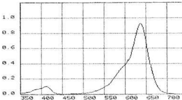
La longueur d'onde pour le max d'absorbance est  $\lambda = 630 \text{ nm}$  (rouge). Il n'y a qu'un pic (principal), on peut utiliser le cercle chromatique pour déterminer la couleur perçue de la solution. L'opposé de rouge est cyan : cela correspond bien à la couleur de la solution.
