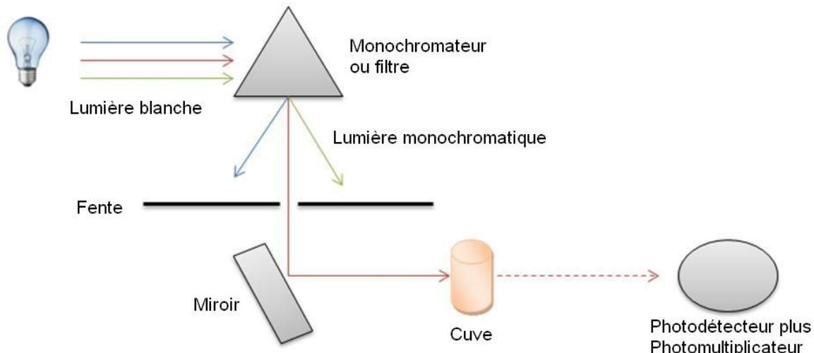
Dans un spectrophotomètre, la lumière est décomposée par un réseau. Une radiation est sélectionnée par une fente. Une partie de la radiation traverse une solution témoin l'autre traverse la solution colorée. En mesurant l'intensité avant et après traversée, on peut en déduire l'absorbance A de la solution. On peut aussi mesurer A pour différentes longueurs d'onde et ainsi obtenir le spectre d'absorbance de la solution colorée.
